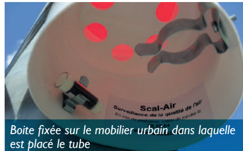
Tube passif pour la mesure des BTEX
