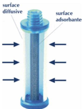
⚡ **Le tube radiello : Les surfaces diffusive et adsorbante sont cylindriques et coaxiales: une grande surface diffusive fait face, à distance constante, à une petite cartouche concentrique.**
