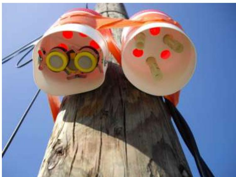
Figure 7 : échantillonneurs passifs installés sur le site de la station du Faubourg Blanchot
