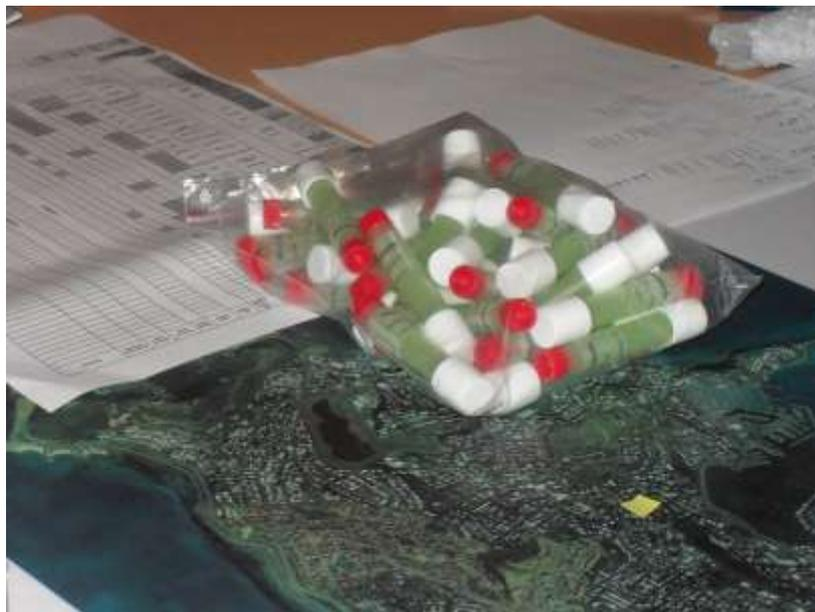
Figure 3 : les tubes passifs NO<sub>2</sub> avant exposition
