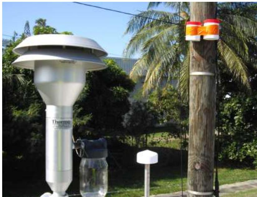
**Figure 15 : échantillonneurs passifs installés au niveau du site de la station de l'Anse Vata**
