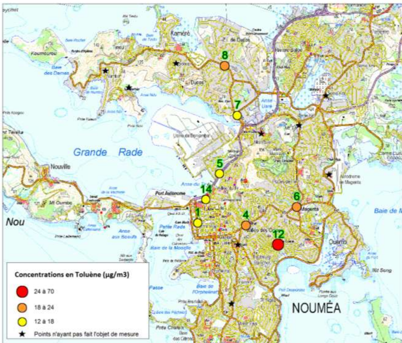
Figure 7 : Concentrations en toluène ( \mu\text{g}/\text{m}^3 ) – campagne de mesure par échantillonnage passif – Nouméa – du 08 au 22 juin 2011
