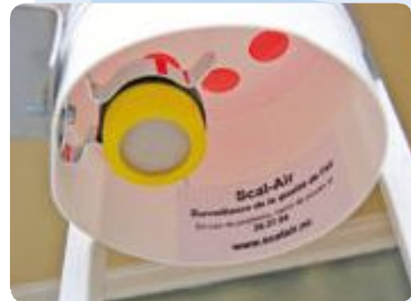
Les tubes passifs sont protégés des intempéries par des boîtes en plastique
