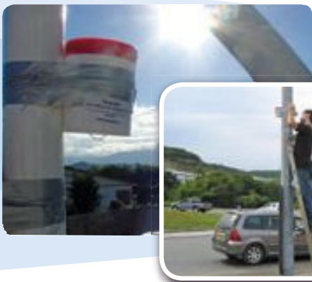
Installation d'un tube passif sur un site « trafic »
