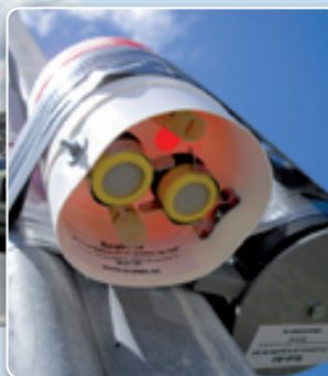
Campagne de mesure par échantillonnage passif sur la ville de Nouméa : installation des dispositifs de mesure sur les sites soumis à la pollution d'origines industrielle et routière
