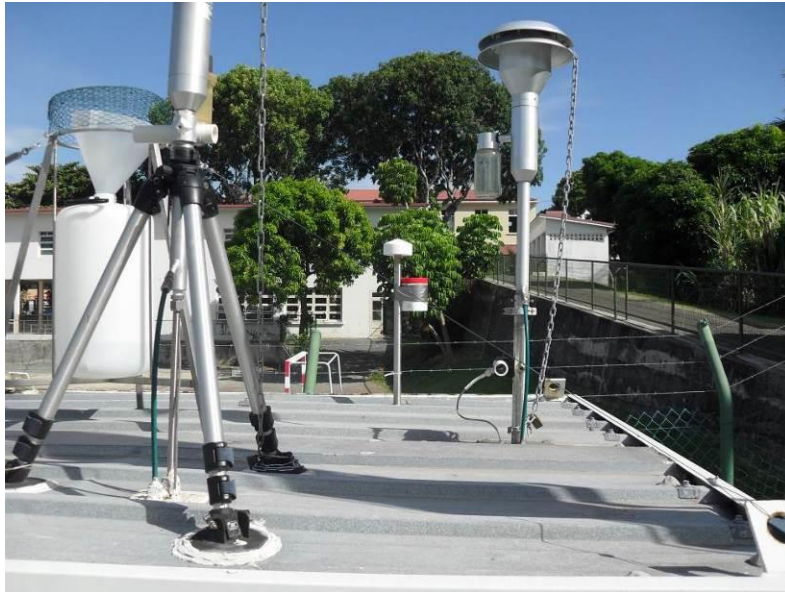
Figure 12 : Echantillonneurs passifs installés sur le site de la station du Faubourg Blanchot (vue du toit), jauge Owen et têtes de prélèvements des analyseurs.
