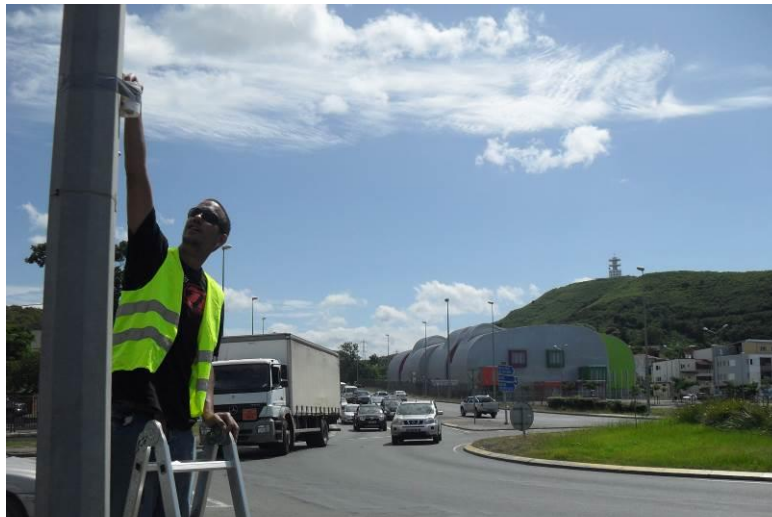
Figure 17 : Pose d'échantillonneurs passifs sur le site du rond-point Berthelot à Nouméa (typologie trafic)
